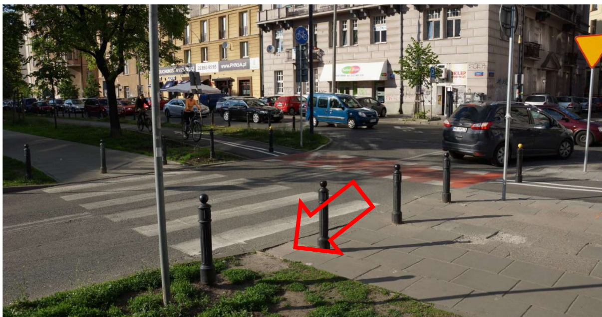
ZDJĘCIE 99 WYDEPTANY TRAWNIK ŚWIADCZĄCY O BRAKU MIEJSCA NA OPUSZCZENIE PRZEJŚCIA
