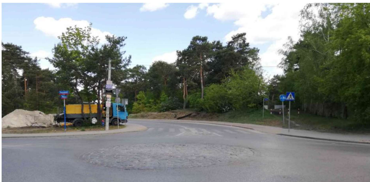
ZDJĘCIE 115 WYSPA NA WŁOCIE RONDA WYZNACZONA PRZEZ POWIERZCHNIĘ WYŁĄCZONĄ Z RUCHU
