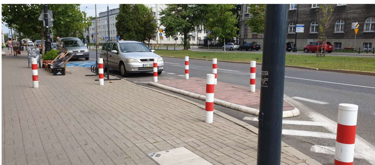
ZDJĘCIE 96 POJAZDY PARKUJĄCE NA WYZNACZONYCH MIEJSCACH OGRANICZAJĄ WIDOCZNOŚĆ KIEROWCY SKRĘCAJĄCEMU W PRAWO
