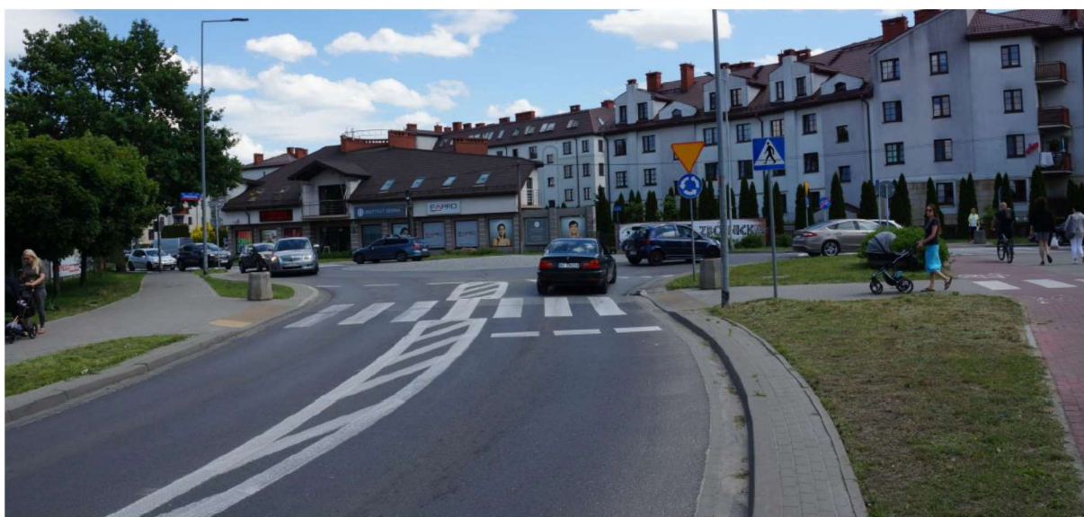
ZDJĘCIE 116 WYSPA NA WŁOCIE RONDA WYZNACZONA PRZEZ POWIERZCHNIĘ WYŁĄCZONĄ Z RUCHU
