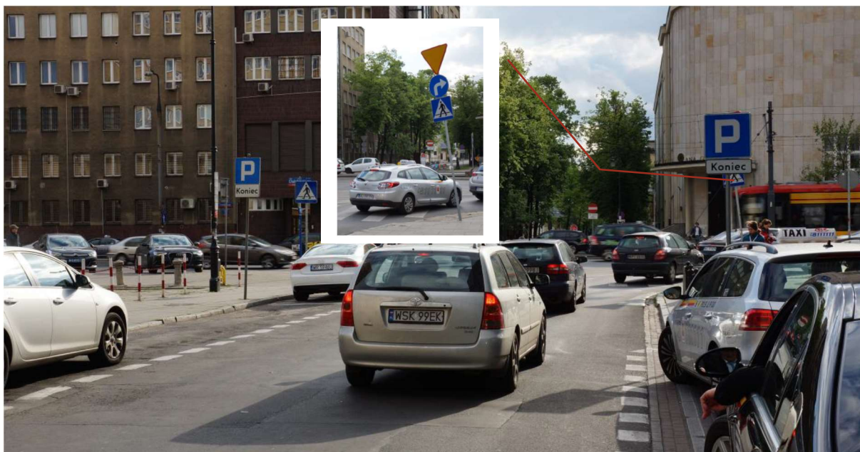
ZDJĘCIE 98 ZASŁONIĘTE OZNAKOWANIE PIONOWE
