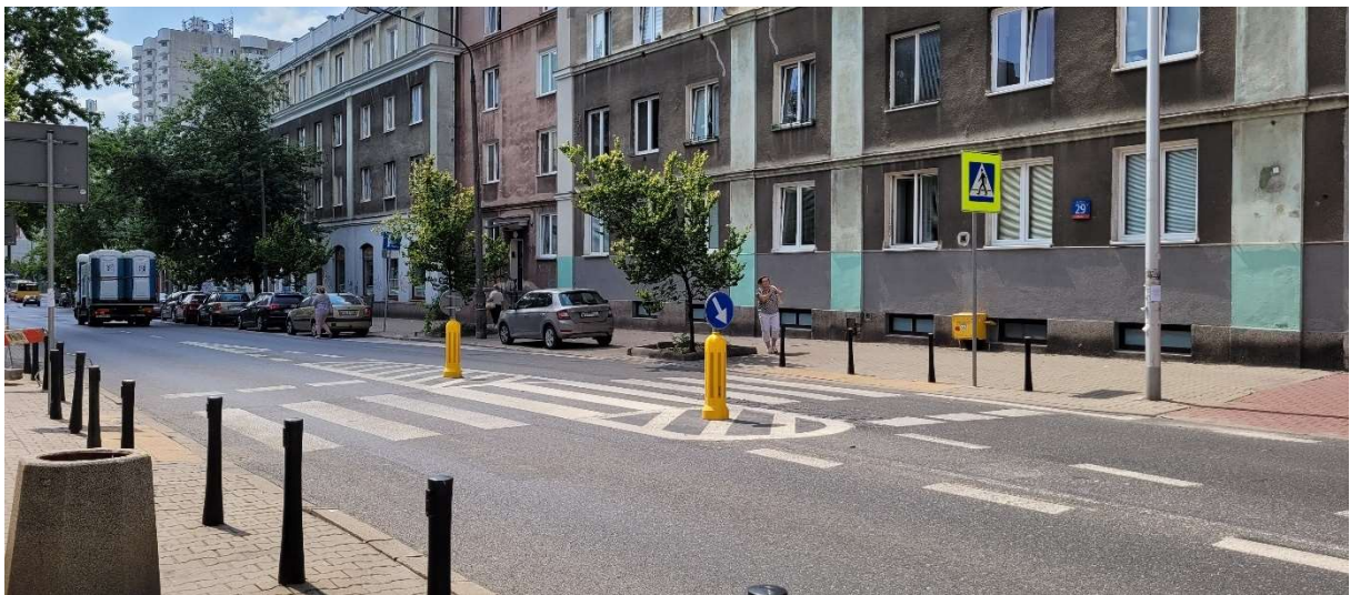
ZDJĘCIE 112 WYSPA AZYLU WYZNACZONA JEDYNIEM POPRZEZ POWIERZCHNIĘ WYŁĄCZONĄ Z RUCHU
