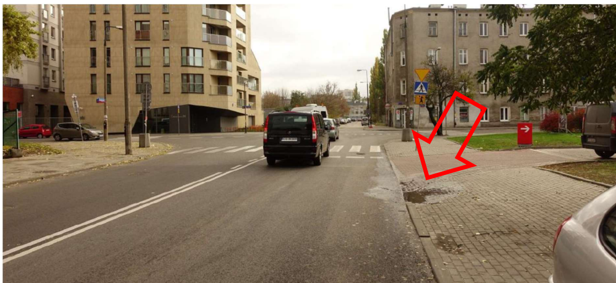
ZDJĘCIE 47 PRZEJŚCIE WRAŻLIWE NA ZASTAWIANIE I OGRANICZENIA WIDOCZNOŚCI. ŚLADY KÓŁ PARKUJĄCYCH POJAZDÓW PRZED PRZEJŚCIEM DLA PIESZYCH
