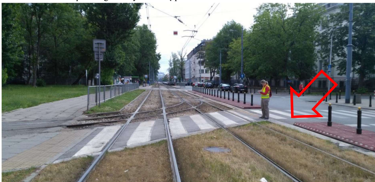
ZDJĘCIE 135 BRAK BEZPIECZNEJ STREFY ZATRZYMANIA PIESZEGO PRZED TOROWISKIEM
